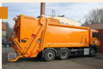
pojazd z zabudową dwukomorową (odpady zmieszane i biodegradowalne)
